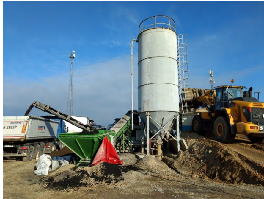
Fot. 1. Mieszarka do recyklingu „na zimno” PRD Lubartów
