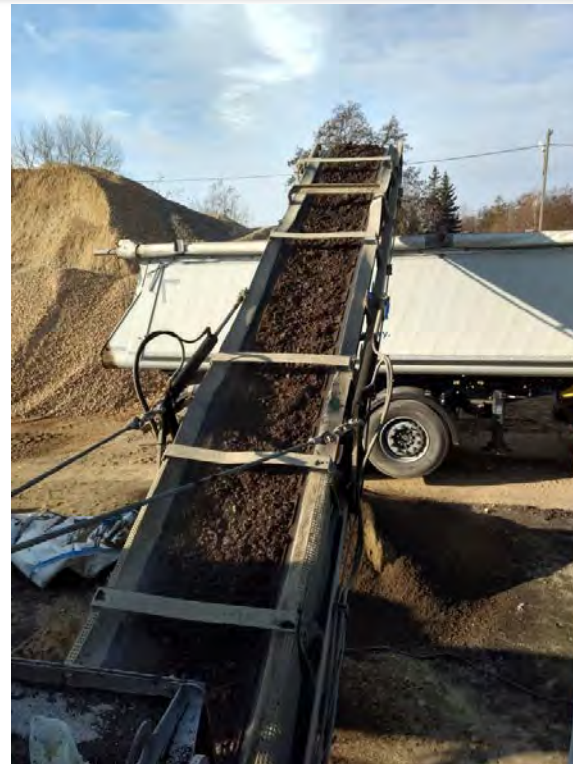
Fot. 2. Mieszarka do recyklingu „na zimno” PRD Lubartów 2018 r.
