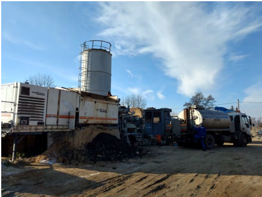
Fot. 1. Mieszarka do recyklingu „na zimno” PRD Lubartów
